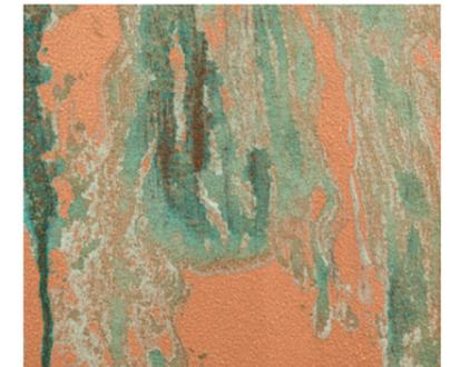
ca. 30 Minuten warten bis der Grünspan sichtbar wird.
